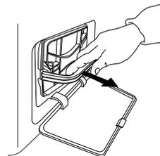
Quite la espuma del filtro inferior para limpiarlo. Limpie la espuma del filtro con la mano o bajo el chorro de agua. No lave la espuma del filtro en la lavadora. Escorra la espuma del filtro. No la introduzca en el filtro inferior mojada.
