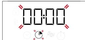
Pomoću ili podesite vreme pripreme hrane koje želite, potom pritisnite da biste potvrdili. Pokrenite funkciju tako što ćete okrenuti dugme termostata na željenu temperaturu: oglasiće se zvučni signal i na ekranu će se prikazati kada je hrana gotova.
