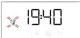
Obratite pažnju na sledeće: Tokom pripreme hrane možete promeniti funkciju tako što ćete uključiti **dugme za odabir** ili podešiti temperaturu uključivši **dugme termostata**. Funkcija neće početi ako je **dugme termostata** na položaju **0 / AUTO** (Automatski). Možete podešiti vreme pripreme, vreme završetka pripreme (samo ukoliko ste podešili vreme pripreme) i tajmer.
