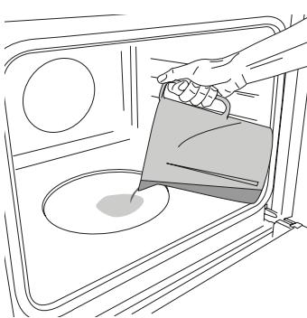
Pred vklopom funkcije uporabe pare na dno pečice nalihte 200 ml pitne vode. Izberite funkcijo, tako da izbirni gumb zavrtite v smeri urinega kazalca na ustrezeni simbol, gumb za nastavitev temperature pa v poljubni položaj med 160 in 180 °C (kot prikazuje simbol). Funkcija se bo zagnala, na zaslonu pa bo prikazan trenutni čas v dnevnu. Predgretje ni potrebno. Za končanje pečenja zavrtite izbirni gumb v položaj „0“. Med kuhanjem s paro ne odpirajte vrat in nikoli ne dolivajte vode.
