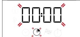
Upotrijebite + ili - za postavljanje potrebnog vremena pečenja i pritisnite za potvrdu. Funkciju uključite okretanjem gumba termostata na potrebnu temperaturu: oglasit će se zvučni signal i na zaslonu će se označiti da je pečenje završeno.
