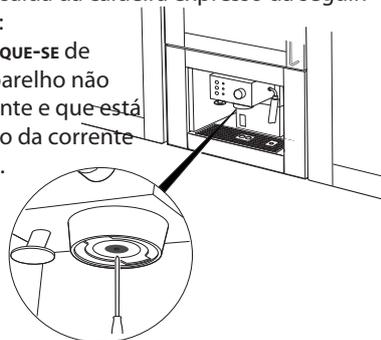
**2. UTILIZANDO UMA CHAVE DE FENDAS**, desaper-te o parafuso que fixa o filtro da saída da caldeira expresso
