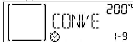
Для выключения таймера сначала остановите действующий режим нажатием **①**, а затем нажмите **◀**.
