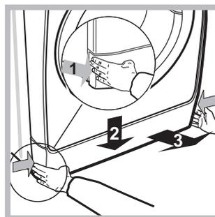
1. verwijder het afdekpaneel aan de voorzijde van de wasautomaat door er op het midden op te drukken. Duw beide zijanten naar beneden toe en verwijder het paneel (zie *afbeeldingen*).
