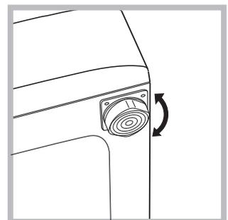
سنجیده می شود نباید از 2 درجه بیشتر باشد. تراز کردن صحیح ماشین باعث می شود تا پایداری لازم را داشته باشد، و از ارتعاشات و صدای بیش از اندازه جلوگیری کرده و نمی گذارد که دستگاه در حین کار به اطراف حرکت کند. اگر ماشین را روی فرش یا موکت قرار می دهید، پایه های آنرا طوری تنظیم کنید که فضای تهویه کافی در زیر ماشین لباس شوئی وجود داشته باشد.
