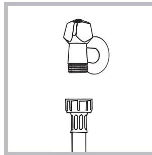
1. Sluit de toevoerbuis aan op de koudwaterkraan met een mondstuk met schroefdraad van 3/4 (zie afbeelding). Voordat u de wasautomaat aansluit moet u het water laten lopen totdat het helder is.
