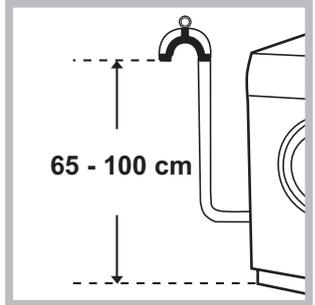
شلنگ تخلیه را بدون اینکه آنرا خم یا تا کنید، به لوله خرطومی فاضلاب یا لوله فاضلاب دیواری که در ارتفاعی بین 65 تا 100 سانتیمتری کف قرار دارد وصل کنید؛
