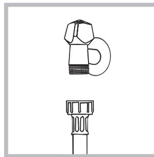
1. Reliez le tuyau d'alimentation en le vissant à un robinet d'eau froide à embout fileté 3/4 (voir figure). Faire couler l'eau jusqu'à ce qu'elle soit limpide et sans impuretés avant de raccorder.
