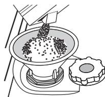
Setzen Sie den Trichter auf (siehe Abbildung) und füllen Sie den Behälter bis zum Rand mit Salz (ca. 1 kg); es ist nicht ungewöhnlich, dass etwas Wasser überläuft.
