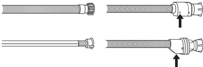
Für Wasserstoppschläuche: Das kleine Sicherheitsventil-Kontrollfenster prüfen (siehe Pfeil). Wenn es rot ist, wurde die Wasserstopffunktion ausgelöst und der Schlauch muss durch einen neuen ersetzt werden. Um diesen Schlauch abzuschrauben, die Entriegelungstaste drücken und dabei den Schlauch abschrauben.
