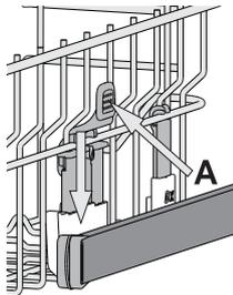
Il cestello superiore è munito di **regolatore in altezza** (vedere figura) che non richiede pressione sulle leve; sollevarlo tenendolo per i lati, non appena si trovi in posizione rialzata.
