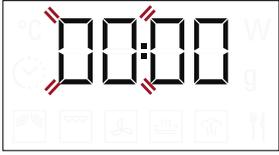
Den *Einstellknopf* drücken, um die korrekte Uhrzeit einzustellen und mit *OK* bestätigen. Die beiden Ziffern für die Minuten beginnen zu blinken. Den *Einstellknopf* drücken, um die korrekte Uhrzeit einzustellen und mit *OK* bestätigen.
