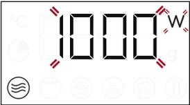
Wenn das Symbol **W** auf dem Display blinkt, den *Einstellknopf* drehen, um die Leistungsstufe zu ändern; dann mit **OK** bestätigen und die folgenden Einstellungen ändern (wenn möglich).
