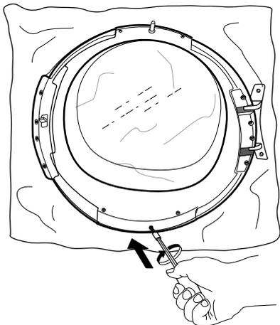
**18.** Insérez le verrou de porte sur le côté droit de l'ouverture de porte. Appuyez dessus totalement à l'intérieur du trou et déplacez-le légèrement vers le bas, jusqu'à ce que le petit bouton du verrou de porte s'enclenche.
