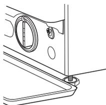
8. Tøm ut vannet: Vri langsomt filteret mot urviseren helt til alt vannet er tømt. La vannet renne ut uten at du fjerner filteret. Når beholderen er full, lukk vannfilteret ved å vri det med urviseren. Tøm beholderen. Gjenta prosedyren helt til alt vannet er tømt.
