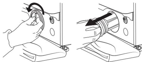
10. Gjør vannfilteret rent: fjern rester i filteret og gjør det rent under rennende vann.
