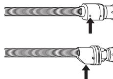
For slanger med vannstopp: sjekk det lille inspeksjonsvinduet til sikkerhetsventilen (se pil). Hvis det er rødt, var funksjonen for vannstopp tettet til, og slangen må byttes ut med en ny. For å skru løs slangen, trykk på knappen for frigjøring (dersom denne er tilgjengelig) mens du skrur løs slangen.
