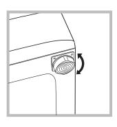
2. Se il pavimento non fosse perfettamente orizzontale, compensare le irregolarità svitando o avvitando i piedini anteriori (vedi figura); l'angolo di inclinazione, misurato sul piano di lavoro, non deve superare i 2°. Un accurato livellamento dà stabilità alla macchina ed evita vibrazioni, rumori e spostamenti durante il funzionamento. In caso di moquette o di un tappeto, regolare i piedini in modo da conservare sotto la lavabiancheria uno spazio sufficiente per la ventilazione.
