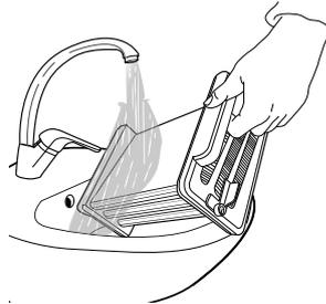
Limpe a câmara do filtro da máquina de secar com um pano húmido ou utilizando cuidadosamente um aspirador. Introduza novamente o filtro inferior. Rode as barras de bloqueio para cima na posição vertical. Feche a aba inferior.
