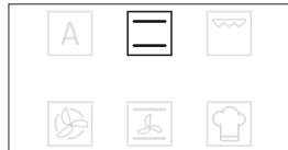
Zur Auswahl einer Unterfunktion (sofern verfügbar), die Hauptfunktion auswählen, anschließend
