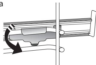
Pour fixer le guide, pressez la partie inférieure de l'agrafe fermement sur le support de grille. Assurez-vous que les grilles ne bougent pas. Répétez ces étapes pour l'autre support de grille du même niveau.
