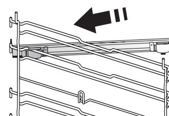
Закрепите верхний зажим направляющей на держателе полок и сдвиньте ее вглубь до упора. Опустите второй зажим в предусмотренное положение.
