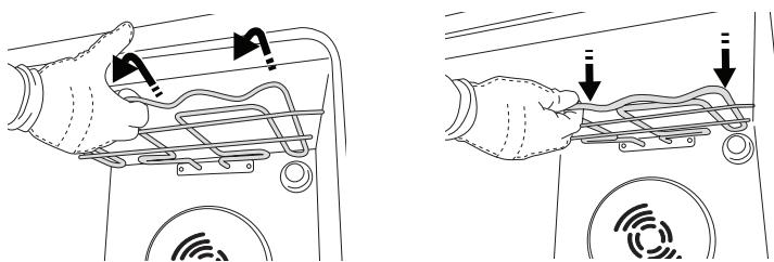
**3.** Для установки нагревательного элемента на место приподнимите его, слегка потянув на себя; проверьте, чтобы элемент опирался на соответствующие боковые держатели.
