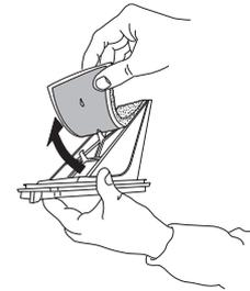
Fije la espuma del filtro en el filtro inferior. Limpie la cámara del filtro de la secadora con un paño o cuidadosamente con una aspiradora. Vuelva a introducir el filtro inferior. Encaje el asa del filtro hacia abajo y cierre la tapa inferior.
