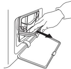
Quite la espuma del filtro inferior para limpiarlo. Limpie la espuma del filtro con la mano o bajo el chorro de agua. No lave la espuma del filtro en la lavadora. Escorra la espuma del filtro. No la introduzca en el filtro inferior mojada.
