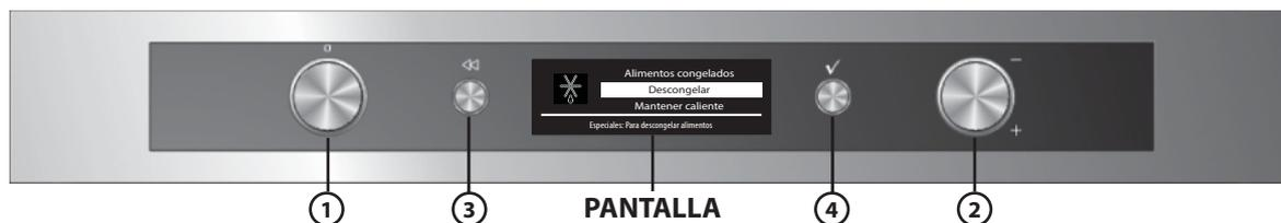
1. **SELECTOR DE FUNCIONES:** encendido/apagado y selección de las funciones
