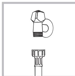
1. Conectați furtunul de alimentare, înșurubându-l la un robinet de apă rece cu gura filetată de 3/4 gaz (a se vedea figura). Înainte de conectare, lăsați apa să curgă până când nu a devenit împedite.
