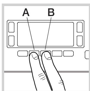
Un messaggio sul display suggerirà regolarmente (ogni 50 cicli circa) di effettuare il ciclo di Auto Pulizia per pulire la lavatrice e combattere la formazione di calcare e cattivi odori. Per una ottimale manutenzione suggeriamo di utilizzare il prodotto
