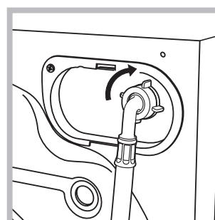
2. Підключіть трубу подачі води до пральної машини, під'єднавши його до водорозбірного крану, який знаходитьться угорі праворучназадньому боці машини (див. малюнок).
