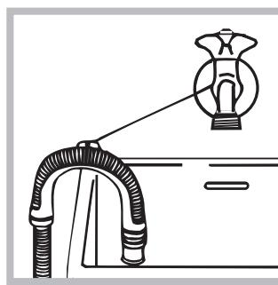
Або ж встановіть вихід зливного шланга на край рукоюйника або ванни, поєднавши напрямну (придбати яку можна у сервісному центрі) до крану (див. малюнок). Не залишайте вільний кінець зливного шланга зануреним у воду.
