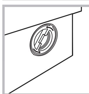
2. odkręcić pokrywę, obracając ją w kierunku przeciwnym do ruchu wskazówek zegara (patrz rysunek): wypłynięcie niewielkiej ilości wody jest normalnym zjawiskiem;
