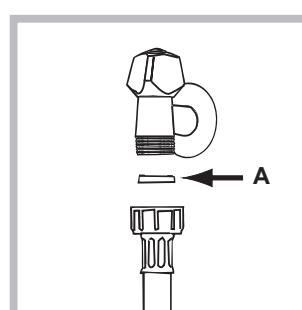
1. Вставте прокладку А у кінець шлангу для подачі води та вкрутіть його у кран з холодною водою з різьбою 3/4 (див. малюнок).
