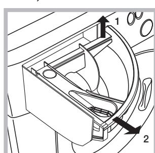
Trageți afară compartimentul ridicându-l și tragându-l spre exterior (a se vedea figura). Spălați-l sub un jet de apă; această operație trebuie efectuată cât mai des posibil.
