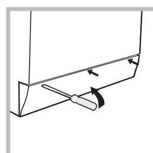
1. scoateți panoul de acoperire din partea din față a mașinii de spălat folosind o șurubelnită (a se vedea figura);
