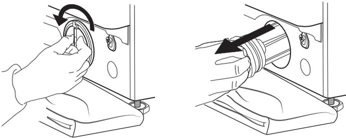
**5.** Reinigen Sie den Wasserfilter: entfernen Sie die Rückstände im Filter und reinigen Sie ihn unter fließendem Wasser.
