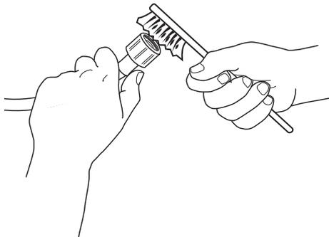
**3.** Schrauben Sie nun den Zulaufschlauch von der Rückseite der Waschmaschine mit der Hand ab. Ziehen Sie das Filtersieb mit einer Zange aus dem Ventil auf der Rückseite der Waschmaschine heraus und reinigen Sie es vorsichtig.
