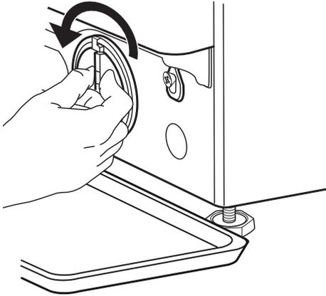
**4.** Entfernen Sie den Filter: Legen Sie ein Baumwolltuch unter den Wasserfilter, der eine geringe Menge an Restwasser aufnehmen kann. Entfernen Sie dann den Wasserfilter indem Sie ihn gegen den Uhrzeigersinn herausdrehen.
