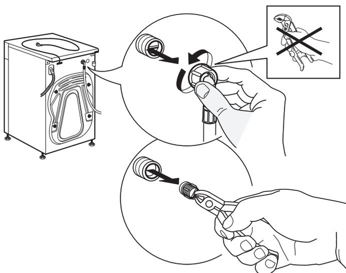
**4.** Filtersieb wieder einsetzen. Schließen Sie den Zulaufschlauch wieder an den Wasserhahn und die Waschmaschine an. Verwenden Sie kein Werkzeug, um den Zulaufschlauch anzuschließen. Öffnen Sie den Wasserhahn und überprüfen Sie, dass alle Anschlüsse dicht sind.
