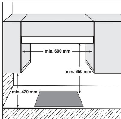
**NOTA: se la distanza "A" tra i pensili è compresa tra 600 mm e 730 mm, l'altezza "B" deve essere minimo 530 mm. Se la distanza "A" tra i pensili è maggiore della larghezza del piano di cottura, l'altezza "B" deve essere minimo 400 mm. Qualora venga installata una cappa sopra il piano di cottura, fare riferimento alle istruzioni di montaggio della cappa per la distanza da rispettare.**
