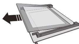
Per riposizionare correttamente il vetro interno, fare attenzione che la "R" sia leggibile nell'angolo destro e che la superficie lucida (non stampata) sia rivolta verso l'alto. Inserire dapprima il lato lungo del vetro indicato dalla "R" nelle sedi di sostegno, quindi abbassarlo in posizione (4). Rimontare il profilo superiore (5): un clic indica il corretto posizionamento. Verificare che la tenuta sia salda prima di rimontare la porta.
