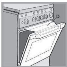
Когда используете гриль, держите дверцу духовки открытой. Чтобы предохранить рукоятки от перегрева поместите защитный экран (дефлектор) D между дверцей и панелью управления (см. рис.).
