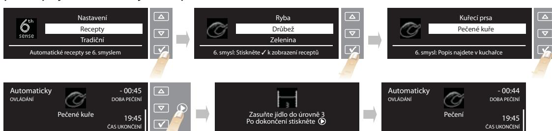
1. Zvolte „RECEPTY“ pomocí tlačítek   a potvrďte pomocí .
