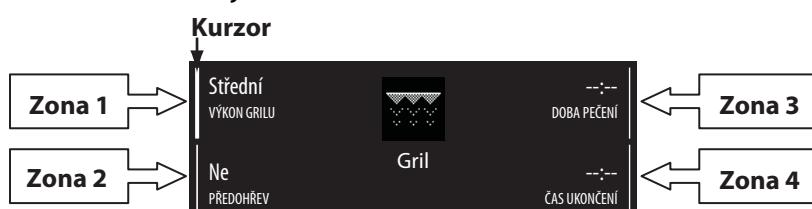
Různými zónami můžete procházet pomocí tlačítek a : kurzor se nastaví u upravitelných hodnot podle výše uvedeného pořadí. Stiskněte tlačítko k volbě hodnoty, upravte ji pomocí a potvrďte tlačítkem .
