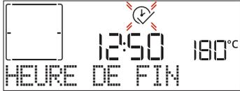
Appuyez sur + ou - pour régler l'heure à laquelle vous souhaitez que la cuisson se termine, puis appuyez sur  pour confirmer et activer la fonction. Placer les aliments dans le four et fermer la porte : La fonction démarre automatique après une période de temps déterminée pour que la cuisson se termine au moment désiré.
