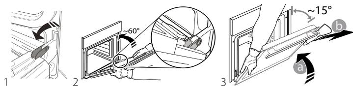
Togliere la porta e appoggiarla su un piano morbido. Per rimontare la porta, avvicinarla al forno allineando i ganci delle cerniere alle proprie sedi e ancorare la parte superiore agli alloggiamenti. Abbassare la porta e poi aprirla completamente. Abbassare i fermi nella posizione originale: fare attenzione che siano completamente abbassati. Provare a chiudere la porta, verificando che sia allineata al pannello di controllo. Se non lo fosse, ripetere tutte le operazioni.
