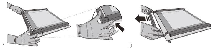
Sollevare e afferrare saldamente il vetro interno con due mani, rimuoverlo e appoggiarlo su un piano morbido prima di eseguire la pulizia (3).
