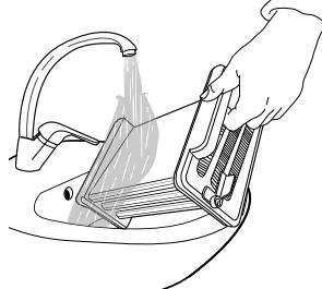
Komoru filtra na sušilici očistite vlažnom krpom ili pažljivo upotrebljavajući usisavač. Ponovno umetnite donji filter. Zaptivne šipke okrenite u okomiti položaj. Zatvorite donja preklopna vratašca.
