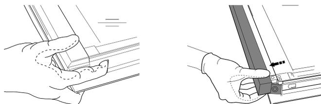
**3.** Внутреннее стекло установлено правильно, если в левом углу видна буква "R", а прозрачная поверхность (без принта) смотрит вверх. Сначала вставьте в пазы (a) длинную сторону стекла с буквой "R", затем опустите его в положение (b).
