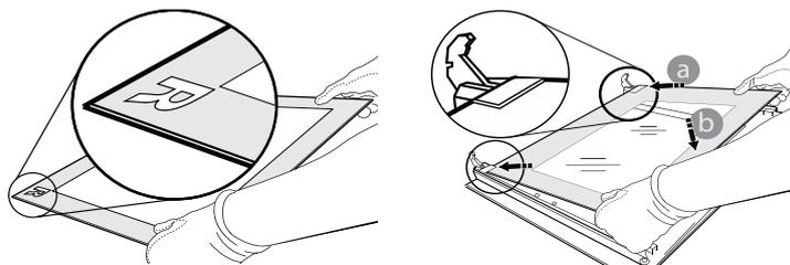
**4.** Зафиксируйте верхний край: Щелчок означает правильную установку. Перед установкой дверцы проверьте целостность уплотнения.
