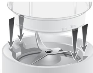
4. Presione hacia abajo y gire el recipiente en el sentido de las agujas del reloj, dando aproximadamente  $\frac{1}{4}$  de giro hacia los dos puntos de resistencia (hasta que se escuchen dos chasquidos).
