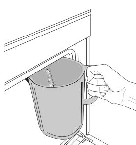
Kada odaberete funkciju „Ispuštanje“, pratite navedene radnje: Otvorite vrata i stavite široku posudu ispod mlaznice za ispuštanje u donjem desnom dijelu ploče. Nakon početka ispuštanja posudu u tom položaju držite sve dok zahvat ne završi. Potrebno je prosječno oko tri minute za ispuštanje
