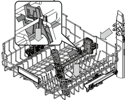
Por vezes, os restos de comida podem acumular-se nos braços aspersores e bloquear os orifícios utilizados para pulverizar a água. Assim, recomenda-se que verifique periodicamente os braços e que os limpe com uma escova pequena não metálica.
