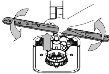
É possível remover o braço aspersor inferior puxando-o para cima e rodando-o no sentido contrário ao dos ponteiros do relógio. A montagem do braço aspersor é feita puxando-o para baixo e rodando-o no sentido dos ponteiros do relógio.
