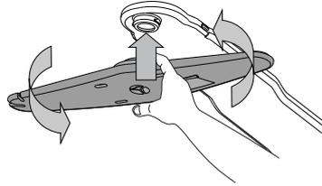
É possível remover o braço aspersor superior pressionando-o para cima e depois rodando-o no sentido contrário ao dos ponteiros do relógio. A montagem do braço aspersor é feita puxando-o para cima e rodando-o no sentido dos ponteiros do relógio.
