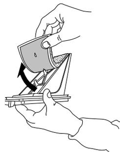
Bringen Sie den Filterschaumstoff am Bodenfilter an. Reinigen Sie die Filterkammer des Trockners vorsichtig mit einem feuchten Tuch oder mit einem Staubsauger. Bodenfilter wieder einsetzen. Klappen Sie den Filtergriff nach unten und schließen Sie die Bodenklappe.
