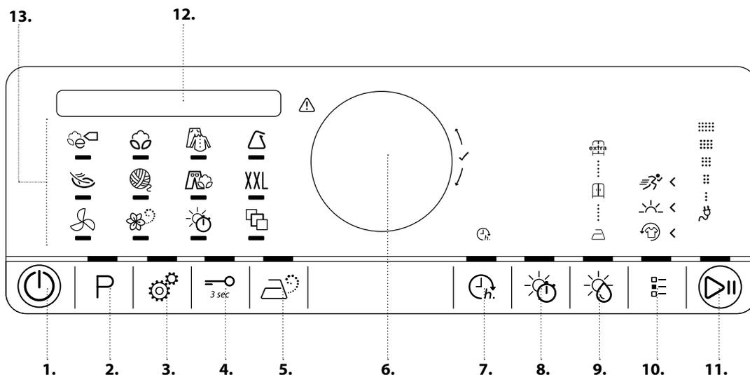
1. An/Aus-Taste (bei langem Tastendruck Rücksetzung)
