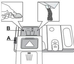
**Per aprire il distributore detersivo utilizzare il dispositivo di apertura A. Versare il detersivo esclusivamente nel distributore B asciutto. Mettere la dose di detersivo per il prelavaggio direttamente all'interno del distributore.**
