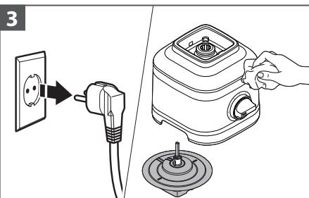
Blender iskopčajte prije čišćenja. Postolje, kabel za napajanje i sklop zupčanika citrusete obrišite krpom navlaženom topлом vodom te osušite mekom krpom.
