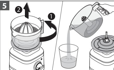
Posudu za sok okrenite suprotno od smjera kazaljke i podignite je za ručku. Izlijte i uzijte!
