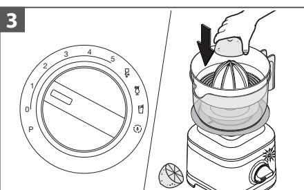
Regulator s (O) okrenite na brzinu 1 ili 2. Prepolovljeni citrus pritisnite na citrusetu. Pokrenite pritiskom na (▷|⊗).
