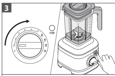
Regulator s (O) okrenite na željenu brzinu ili gotovi program. Pokrenite pritiskom na (▷⊗). Dodatne pojedinosti potražite u poglavljiju „Vodič kroz funkcije blendera“.
