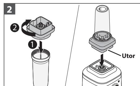
Sklop s noževima pričvrstite za vrč i okrećite ga u smjeru kazaljke na satu dok ne bude čvrsto zategnut.
