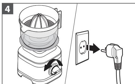
Zaustavite pritiskom na (▷|⊗). Regulator okrenite na (O). Iskopčajte blender.
