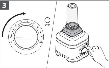
Regulator s (O) okrenite na željenu brzinu ili gotovi program. Pokrenite pritiskom na (▷|⊗). Dodatne pojedinosti potražite u poglavljiju „Vodič kroz funkcije blendera“.
