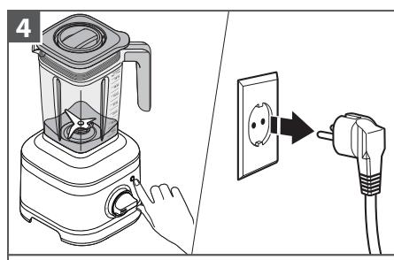
Kad je priprema gotova, blender zaustavite pritiskom na (▷⊗). Iskopčajte blender iz utičnice prije no što skinete vrč.
