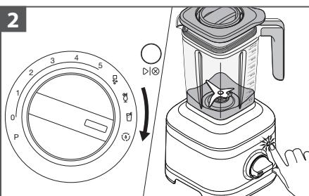
Regulator s (O) okrenite na (◎). Pokrenite pritiskom na (▷◎). Kad se ciklus završi, skinite vrč, ispraznite ga, isperite topлом vodom i dobro osušite.
