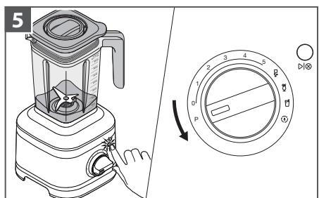
**Pulsiranje:** Pritisnite ( $\text{D}|\text{O}$ ). Regulator s (**O**) okrenite na (**P**) i tako ga držite koliko je potrebno.
