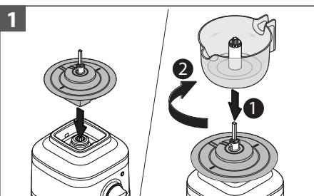
Na postolje postavite sklop zupčanika. Na sklop zupčanika postavite posudu za sok i okrenite u smjeru kazaljke na satu kako biste je pričvrstili.
