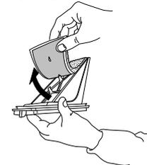
Fixe a espuma ao filtro inferior. Limpe a câmara do filtro da máquina de secar com um pano húmido ou utilizando cuidadosamente um aspirador. Introduza novamente o filtro inferior. Empurre o manípulo do filtro para baixo e feche a aba inferior.
