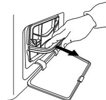
Remova a espuma do filtro inferior, para limpar. Limpe a espuma do filtro e o filtro manualmente ou sob água corrente. Não lave a espuma do filtro na máquina de lavar roupa. Torça a espuma do filtro. Não a insira no filtro inferior a pingar água.
