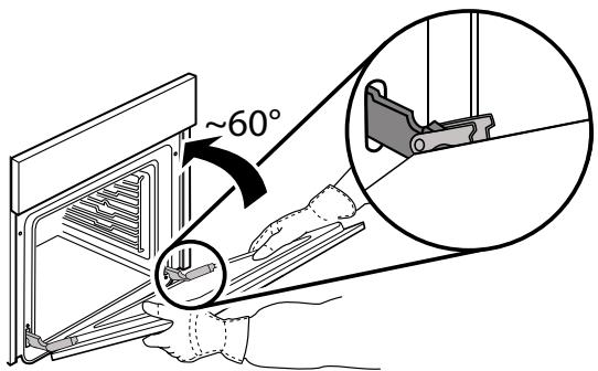
4. Надежно захватите дверцу обеими руками (не за ручку). Снимите дверцу, одновременно закрывая и смещая ее вверх.
