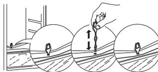
régulièrement l'intérieur de l'orifice d'évacuation situé sur la paroi arrière du compartiment réfrigérateur, à proximité du bac à fruits et légumes, à l'aide de l'outil fourni avec l'appareil.
