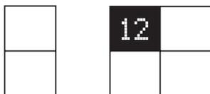
Jede Kochzone bietet verschiedene Leistungsstufen von „1“ (niedrigste Stufe) bis „18“ (höchste Stufe). Mit dem Schieber-Touchscreen können Sie auch die Funktion Schnellaufheizen auswählen, die mit dem Buchstaben „P“ auf der Anzeige erscheint.
