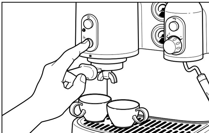
**11.** La macchina per caffè espresso è equipaggiata con un'elettrovalvola a 3 vie che scarica istantaneamente la pressione nel gruppo di infusione quando la pompa dell'acqua viene spenta. È quindi possibile rimuovere il portafiltro immediatamente dopo l'erogazione del caffè. Rimuovere il portafiltro spostando la maniglia a sinistra. Quando si fanno cadere i fondi di caffè dal filtro, evitare di dare colpi sulla maniglia del portafiltro.
