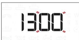
Die beiden Ziffern für die Minuten beginnen zu blinken. Den Einstellknopf drücken, um die korrekten Minuten einzustellen und **OK** zur Bestätigung drücken.
