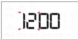
Die beiden Ziffern für die Stunden beginnen zu blinken: Den *Einstellknopf* drücken, um die korrekte Uhrzeit einzustellen und **OK** zur Bestätigung drücken.
