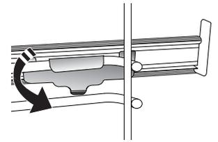
Nota: Las guías deslizantes se pueden montar en cualquier nivel.
