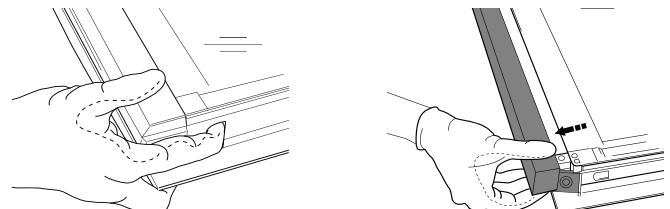
**3.** Внутреннее стекло установлено правильно, если в левом углу видна буква "R", а прозрачная поверхность (без принта) смотрит вверх. Сначала вставьте в пазы длинную сторону стекла с буквой "R", затем опустите его в предусмотренное положение.
