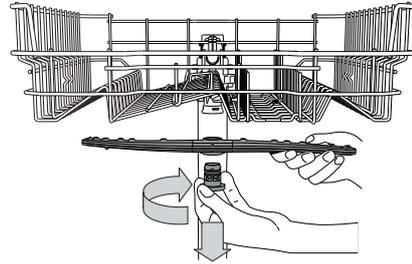
Zur Abnahme des oberen Sprüharms drehen Sie den Kunststoffring gegen den Uhrzeigersinn ab. Der obere Sprühharm ist mit jener Seite nach oben wieder einzusetzen, die die meisten Löcher aufweist.
