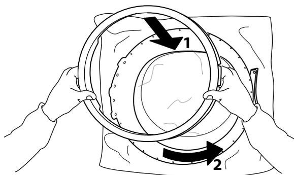
**17.** Vuelva a girar la puerta y póngala boca abajo. Vuelva a colocar el tornillo inferior.
