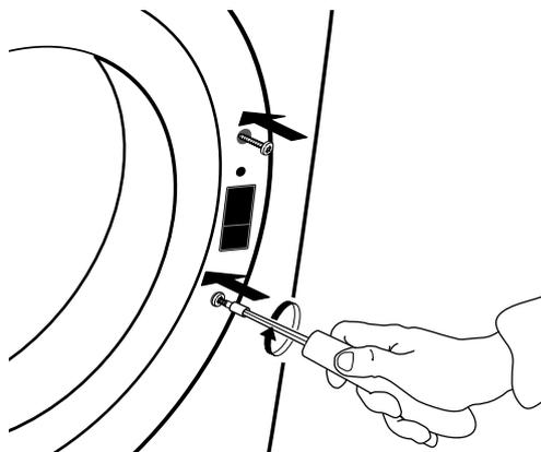
**20.** Fije la puerta a la izquierda de la abertura de la puerta enroscando los dos tornillos.
