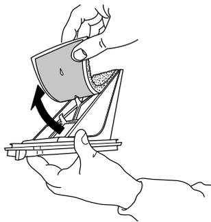
**4.** Limpie la espuma del filtro con la mano o bajo el chorro de agua. No lave la espuma del filtro en la lavadora.
