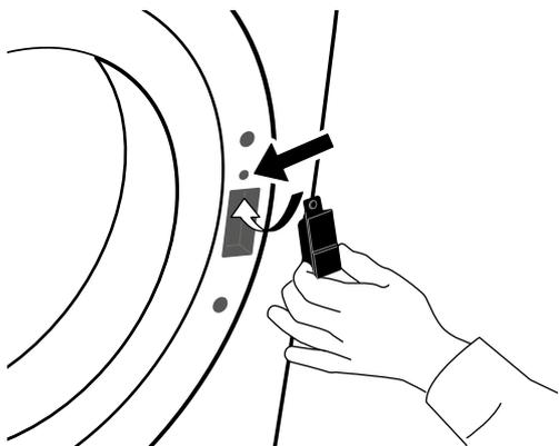
**19.** Coloque los dos tornillos encima y debajo del cierre, a la derecha de la abertura de la puerta.
