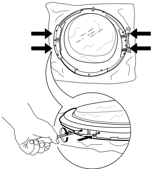
**14.** Vuelva a colocar los 4 tornillos interiores en ambos lados.
