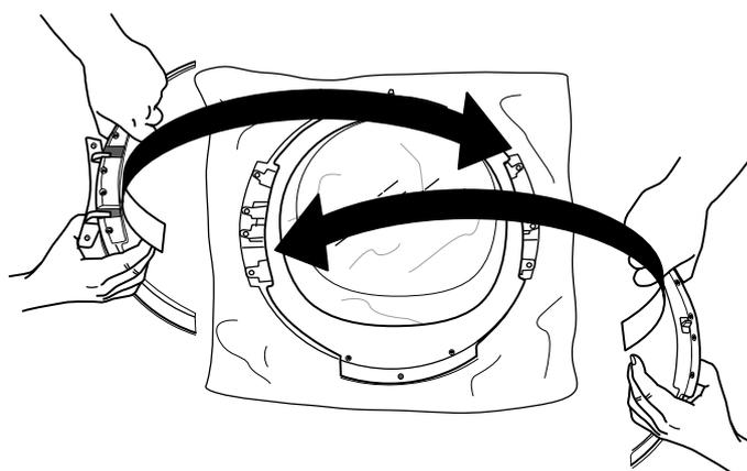
**13.** Vuelva a colocar los 2 tornillos laterales en ambos lados de la puerta.
