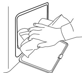
**8.** Vuelva a introducir el filtro inferior. Asegúrese de que quede totalmente encajado en la cámara del filtro.
