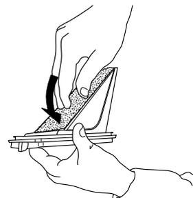
**7.** Limpie la cámara del filtro de la secadora con un paño o con una aspiradora.
