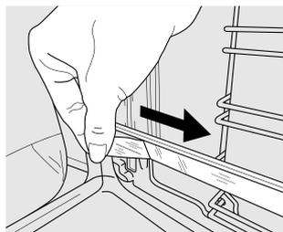
**RIMOZIONE DELLE GUIDE DI SCORRIMENTO [c]**
