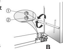
5. Réglez les vis de mise à niveau à l'aide de la clé fournie (si présente). Tournez dans le sens des aiguilles d'une montre pour soulever l'appareil, et dans le sens contraire pour l'abaisser. Il peut s'avérer nécessaire d'effectuer plusieurs tours avec les vis de mise à niveau et/ou les pieds pour régler l'inclinaison du réfrigérateur.
