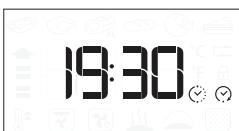
Upozornění: Naprogramování času spuštění odloženého pečení deaktivuje fázi předehřívání trouby. Trouba dosahuje požadované výšce teploty postupně, což znamená, že doby přípravy mohou být o něco delší, než je uvedeno v tabulce pro tepelhou úpravu pokrmů.
