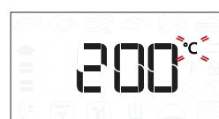
Ked' na displeji bliká ikonka °C/°F, otáčaním gombíka zmeňte hodnotu, potvrdte stlačením ⑥ a pokračujte zmenou ďalších nastavení (ak je to možné).
