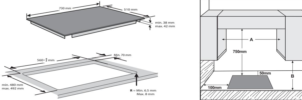
**NOTA:** si la distancia "A" entre los armarios de la pared es de 600 mm a 730 mm, la altura "B" debe ser de de 530 mm como mínimo. Si la distancia "A" entre los armarios de la pared es mayor que la anchura de la zona de trabajo, la altura "B" debe ser de 400 mm como mínimo. Si se instala un extractor sobre la superficie de cocina, consulte las instrucciones del extractor para saber cuál es la distancia correcta
