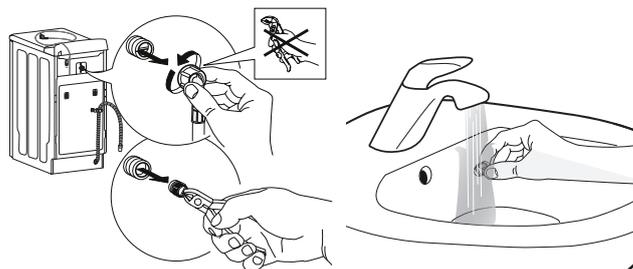
4. Remplacez le filtre à tamis. Rebranchez le tuyau d'alimentation au robinet d'eau et au lave-linge. N'utilisez pas d'outils pour brancher le tuyau d'alimentation. Ouvrez le robinet d'eau et assurez-vous que tous les raccords sont bien serrés.
