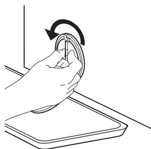
4. Enlevez le filtre : Votre lave-linge comprend plusieurs fonctions de sécurité et de rétroaction automatiques. Puis enlevez le filtre à eau en le tournant dans le sens contraire aux aiguilles d'une montre.
