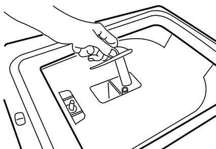
3. Réinstallez le distributeur en plaçant les languettes inférieures du distributeur dans les ouvertures appropriées sur le couvercle, et en poussant le distributeur contre le couvercle jusqu'à ce qu'il se mette en place.
