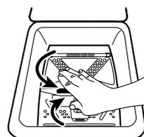
**ATTENTION :** Vérifiez que le linge ne reste pas coincé entre les volets ou entre les volets et le tambour. Assurez-vous que les volets du tambour sont convenablement verrouillés - en fonction du modèle :
