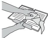
6. Réinsérez l'accessoire en plaçant la partie arrière sur les projections indiquées sur la figure, puis resserrez la poignée de l'accessoire sur les fermoirs ci-dessus.
