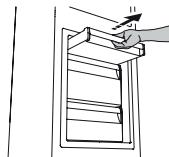
2. Odvojite dodatak STOP FROST i uklonite ga, vodeći računa da ga ne ispuštate na staklenu policu ispod.
