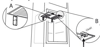
7. Ponovo umetnite gornju fioku i zatvorite vrata odeljka zamrzivača. Dodatak STOP FROST možete da očistite odvojeno bez potpunog odleđivanja odeljka zamrzivača.
