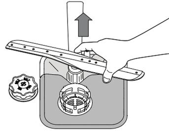
El brazo aspersor inferior se puede desmontar ejerciendo presión hacia arriba.
