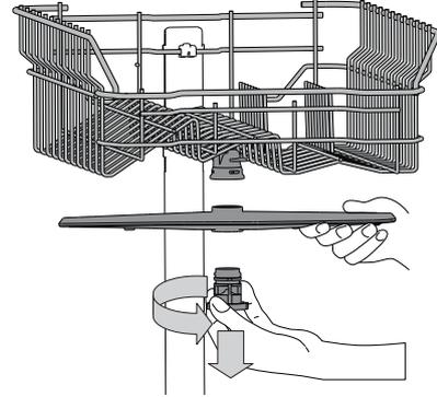
Para extraer el brazo aspersor superior, gire el anillo de cierre de plástico hacia la izquierda. El brazo rociador superior se tiene que recolocar de tal modo que el lado con más agujeros mire hacia arriba.
