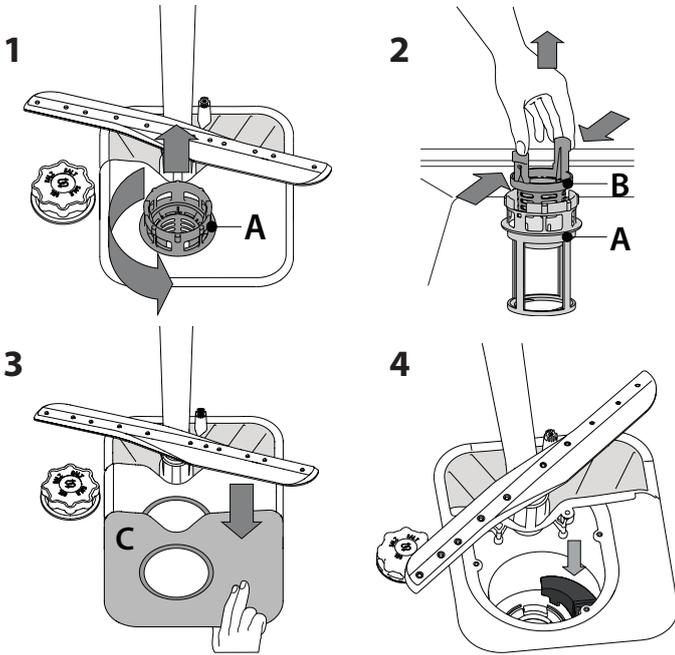
Una vez limpiados los filtros, recoloque el cuerpo de filtrado y encájelo correctamente en su sitio; esto es esencial para garantizar el funcionamiento eficiente del lavavajillas.
