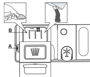
**Para abrir el dispensador de detergente utilice el mecanismo de apertura A. Introduzca el detergente solo en el dispensador B seco. Eche la cantidad de detergente para el prelavado directamente dentro de la cuba.**
