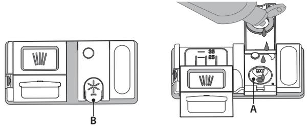
1. Ouvrez le distributeur **B** en appuyant et en tirant sur l'onglet sur le couvercle.
